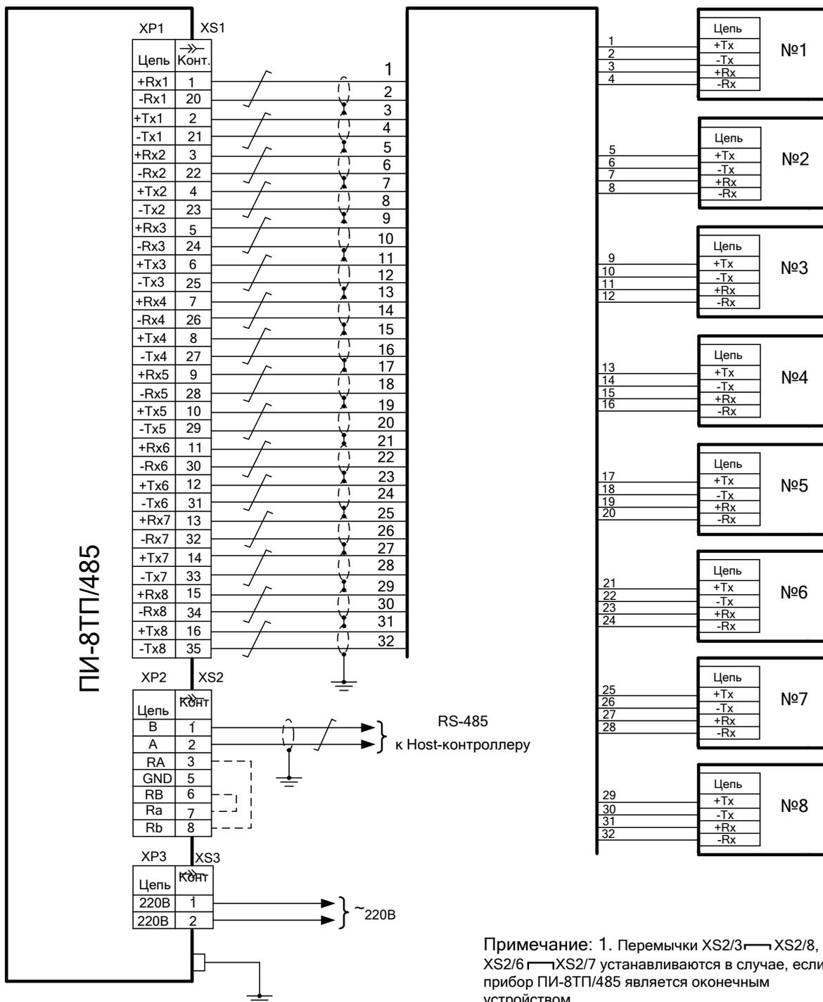
Примечание: 1. Перемычки XS2/3 — XS2/8, XS2/6 — XS2/7 устанавливаются в случае, если прибор ПИ-8ТП/485 является оконечным устройством.
